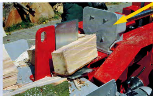
Variable Spaltmesser: Komplett hochgefahren (links) schafft das Vierfach-Kreuz auch starke Durchmesser, vollständig eingefahren (oben) kann dünneres Holz auch nur einfach gespalten werden. Die Druckplatte (Pfeil oben) ist so konstruiert, daß sie Druckkräfte ableiten soll. Deswegen besitzt die rückseitig in der Platte eingelassene Kolbenstange etwas Spiel (unten links), um mit den Kräften zu schwingen. Das Spaltkreuz (unten) liegt am Rahmen ohne Verschraubung nur auf, um sich ebenfalls mit dem Holz zu bewegen. Fotos: Riemann
