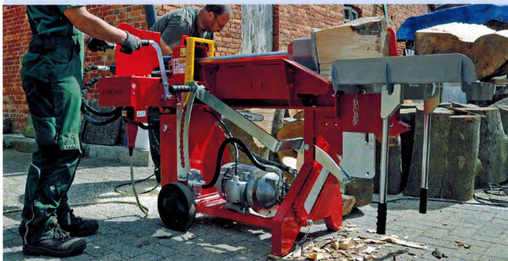
Drei Beine wackeln nie, vier Beine immer: Zum Ausgleich muß ein Standfuß austariert werden, insgesamt steht der Spalter dann während der Arbeit sehr stabil. Über die Griffe am Spalttisch (rechts im Bild) kann der 275 Kilogramm schwere Holzspalter auch bequem geschoben werden. Gewöhnungssache: Geschaltet wird die Zweihand-Sicherheitsbedienung mit nach vorne stehenden Hebeln – wie bei einem Rollator (unten links). Der Spalthub läßt sich durch einen Splint in drei Stufen begrenzen (unten rechts).
