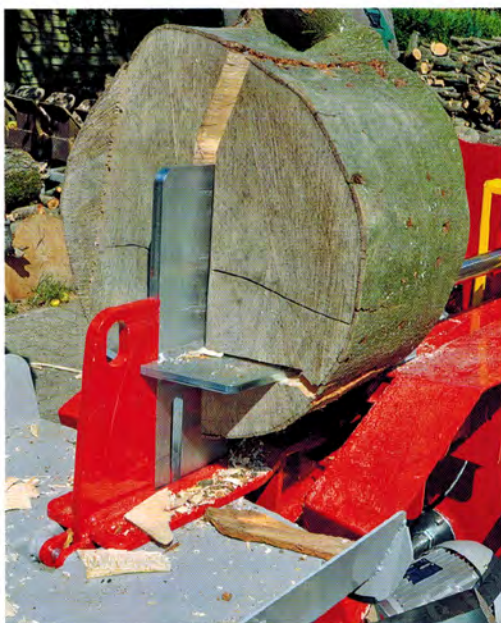
Variable Spaltmesser: Komplett hochgefahren (links) schafft das Vierfach-Kreuz auch starke Durchmesser, vollständig eingefahren (oben) kann dünneres Holz auch nur einfach gespalten werden. Die Druckplatte (Pfeil oben) ist so konstruiert, daß sie Druckkräfte ableiten soll. Deswegen besitzt die rückseitig in der Platte eingelassene Kolbenstange etwas Spiel (unten links), um mit den Kräften zu schwingen. Das Spaltkreuz (unten) liegt am Rahmen ohne Verschraubung nur auf, um sich ebenfalls mit dem Holz zu bewegen. Fotos: Riemann
