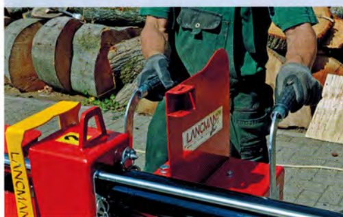
Drei Beine wackeln nie, vier Beine immer: Zum Ausgleich muß ein Standfuß austariert werden, insgesamt steht der Spalter dann während der Arbeit sehr stabil. Über die Griffe am Spalttisch (rechts im Bild) kann der 275 Kilogramm schwere Holzspalter auch bequem geschoben werden. Gewöhnungssache: Geschaltet wird die Zweihand-Sicherheitsbedienung mit nach vorne stehenden Hebeln – wie bei einem Rollator (unten links). Der Spalthub läßt sich durch einen Splint in drei Stufen begrenzen (unten rechts).
