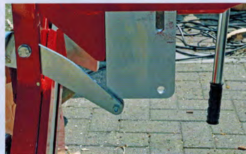
Variable Spaltmesser: Komplett hochgefahren (links) schafft das Vierfach-Kreuz auch starke Durchmesser, vollständig eingefahren (oben) kann dünneres Holz auch nur einfach gespalten werden. Die Druckplatte (Pfeil oben) ist so konstruiert, daß sie Druckkräfte ableiten soll. Deswegen besitzt die rückseitig in der Platte eingelassene Kolbenstange etwas Spiel (unten links), um mit den Kräften zu schwingen. Das Spaltkreuz (unten) liegt am Rahmen ohne Verschraubung nur auf, um sich ebenfalls mit dem Holz zu bewegen. Fotos: Riemann
