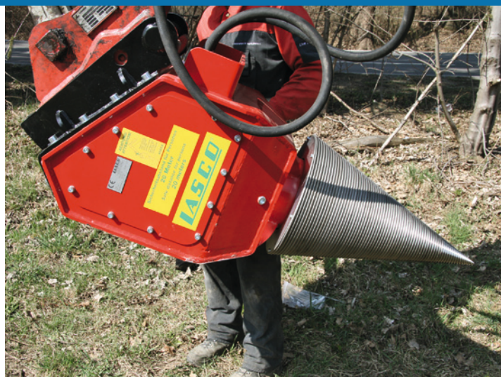
Der Kegeldurchmesser beträgt bei dieser Maschine 420 mm.
