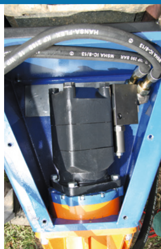
Bei Deitmer treibt nur ein doppelwirkender Hydraulikmotor den Kegel an.
