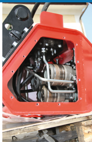
Bei unserem Testmodell treiben je nach Kraftbedarf bis zu drei Motoren den Kegel an.
