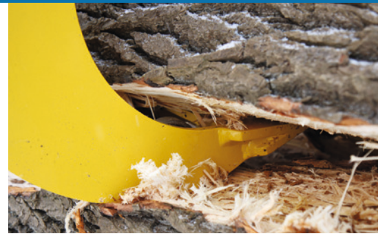
Die Zangenspitze ist so geschwungen, dass sie das Holz auseinanderdrückt.
