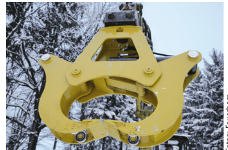
Die Perzl-Zange ist sehr robust, aber dafür mit 340 kg am schwersten.
