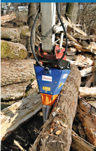
Das Gehäuse ist die Weiterführung des Kegels und drückt das Holz weiter auseinander.
